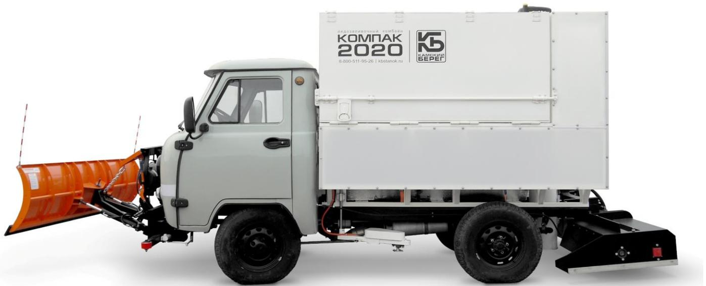
Многофункциональная машина бюджетного класса, предназначенная для обслуживания открытых и закрытых катков, хоккейных площадок, стадионов, беговых дорожек с естественным и искусственным ледяным покрытием. Машина построена на базе модернизированного шасси УАЗ 3303.
